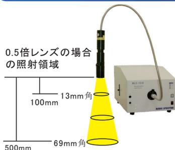
正確な分光感度/量子効率測定では、セル全域へ単色光の照射が必要です。市販されている多くの分光感度測定器は、3mm角/5mm角/10mm角ですので、それ以上大きなセルは正確な分光感度測定は期待できません。本測定システムの分光光源は、レンズのフォーカスの調整で照射領域を広範囲に可変できます。(左図参照) また、レンズの交換でさらに広範囲の単色光照射が可能になります。(照射領域の拡大とともに、光量は低下します。) 詳細は、朝日分光社ロッドレンズの仕様に準じます。
