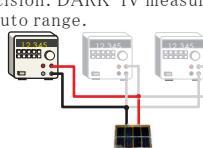
**STEP-2** 3台を全て並列動作で、大電流のDARK-IV測定をします。
