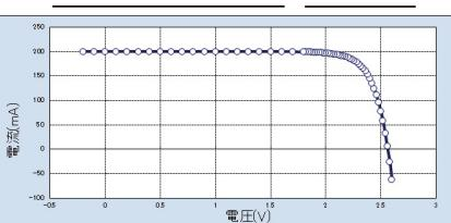
スイープ測定の途中から、測定ステップ幅の切換が可能です。通常なら広い測定値となってしまう最大出力付近から開放電圧までを細かく測定できます。
