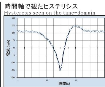
色素増感型太陽電池の光照射に対する応答遅れの評価を行います。
