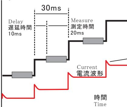
シリコン系太陽電池において、本ソフトを使用して太陽電池のIV測定値から特性パラメータを算出する場合、適切な電圧測定範囲なら、サンプリング時間間隔「30ms」、データ数「30個」が推奨条件です。
