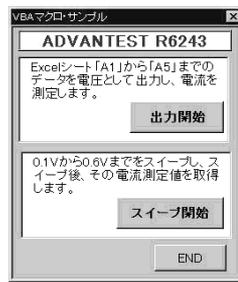
Excelに入力された数値を電圧として出力し、同時に電流測定をする例
