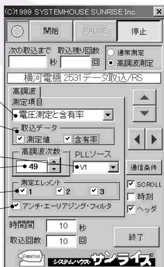
測定側で設定した条件と全て同じ条件に設定してください。
