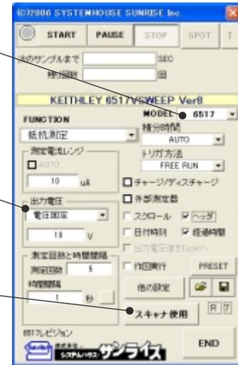
測定器からデータの取込を開始します。「PAUSE」ボタンを先に押してから、「START」ボタンを押すとスポット測定モードになり、「SPOT」ボタンによるスポット測定が可能になります。
