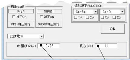
「比誘電率」「体積抵抗率」「導電率」の計算を行なう場合に選択します。ただし、「比誘電率」を計算させるためには、先頭画面のFUNCTION指定に「C」を含む適切なFUNCTIONを指定してください。「Cp-D」「Cs-Q」などです。また「体積抵抗率」「導電率」を計算させるためには、上記画面の左側の追加測定FUNCTIONに「R」を含む適切なFUNCTIONを指定してください。「Lp-Rp」「Ls-Rs」「R-X」などです。上記のFUNCTIONの設定が満足されないと計算結果はExcelシートに入力されません。真空の誘電率は、「8.854187816E-12」として計算されます。
