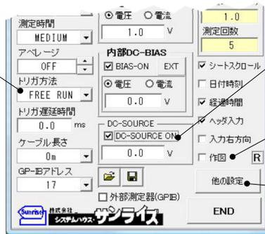
測定器にOPT.001が搭載されている場合にだけ選択が可能です。DC-SOURCEのON/OFFの選択とその出力レベルを入力します。
