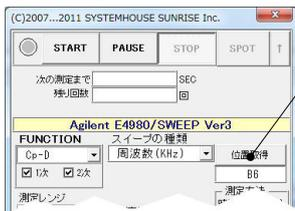
空欄のセルにカーソルを置いて、ここをクリックすると、右の画面が表示され、スイープデータリストをExcelシートに自動入力できます。セルが空欄ではない場合は、右の画面は表示されず、現在のセル位置のデータが、スイープデータとして使用されます。
