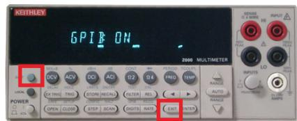
測定器のGP-IBアドレスを任意のアドレスに設定し「ENTER」ボタンで確定します。
