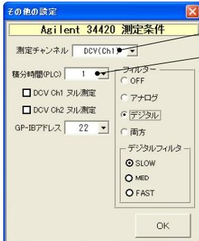
測定チャンネルを指定します。通常は「DCV1」を選択します。
