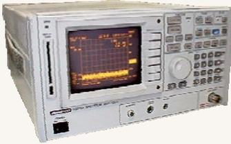
R3261A/B/C/D画面上の「スペクトル波形」「Max Peak」をExcelシートに取込み、必要なら自動的に作図を行います。
