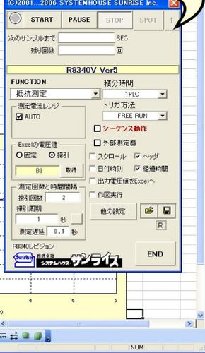
Excelシートに取込んだデータは、キーボードから入力したデータと同じように、Excelの機能を利用して、作図・編集・計算等を自由に行うことができます。また、事前にデータが取込まれる領域をExcelのグラフィックで設定することが可能ですからデータ取込と同時にグラフ化がリアルタイムに行えます。
