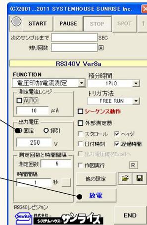
測定器からデータの取込を開始します。「PAUSE」ボタンを先に押してから、「START」ボタンを押すとスポット測定モードになり、「SPOT」ボタンによるスポット測定が可能になります。
