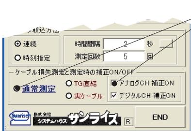
「通常測定」と「アナログ補正ON」/「デジタル補正ON」にチェックをつけて実際の測定を開始すると、上記で測定したケーブル損失量を補正した測定結果が得られます。実際は、「アナログ補正ON」にチェック付けた状態で測定を開始すると、「NTSC」と「PILOT」の各チャンネルの下のセルにある数値を測定値に対しマイナスします。「デジタル補正ON」にチェック付けた状態で測定を開始すると、「ISDB-T」「CATV」「BS」「CS」の各チャンネルの下のセルにある数値を測定値に対しマイナスします。両方にチェックをつけると、アナログ/デジタルの両チャンネルのケーブル補正が行われます。セルが空欄の場合は、補正ゼロになります。このセルの数値は、手入力した数値であった場合でも同じ補正が行われます。
