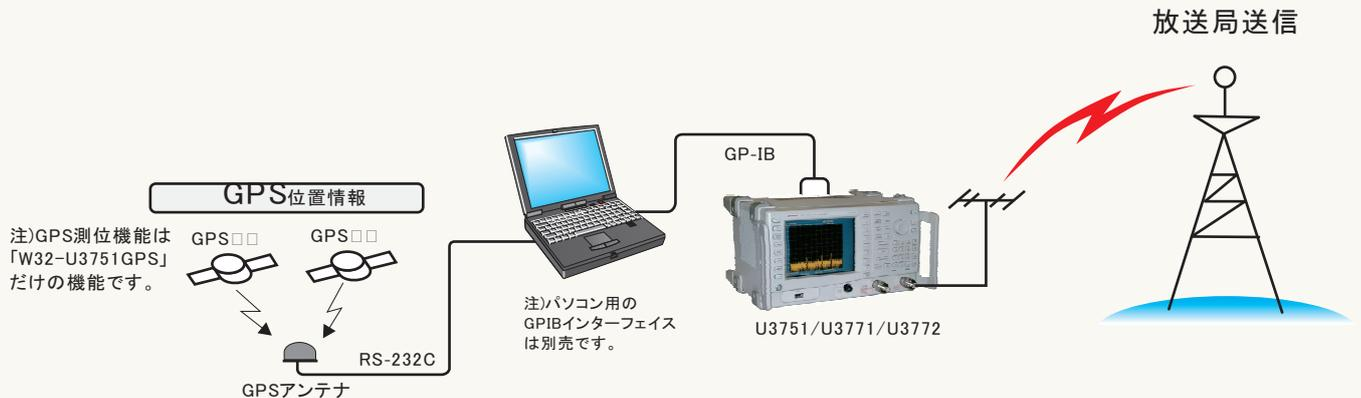
◆1.最大250CHまでのデジタル/アナログチャンネルのCNR,信号レベル,OBWを自動的に測定します。
