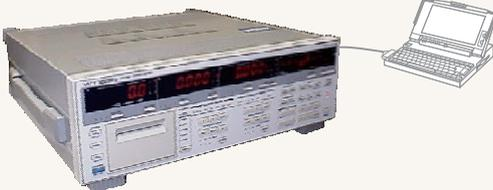
指定された時間間隔で指定された数の電圧・電流・ワット・周波数等の全ての測定項目のデータを直接Excelのシートに取込みます。
